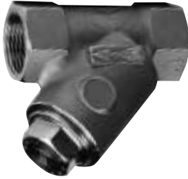
Schmutzfänger mit Innengewinde DIN 2999 PN 40, mit Sieb Maschenweite 0,5 mm, andere Maschenweiten auf Anfrage
